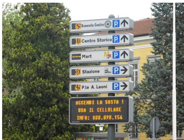
Esempio di segnaletica di indirizzamento ai parcheggi a messaggio variabile (Rovereto)
