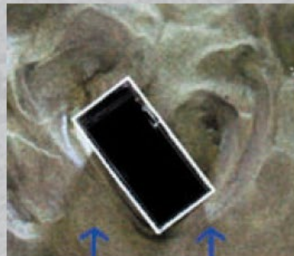
Vista dall'alto di un ostacolo rettangolare posto su fondo sabbioso in seguito a simulazione di piena: si vede l'erosione del suolo in prossimità degli angoli, le frecce blu indicano la direzione della corrente. Immagine di laboratorio, Dipartimento di Idraulica, università degli Studi di Pavia
