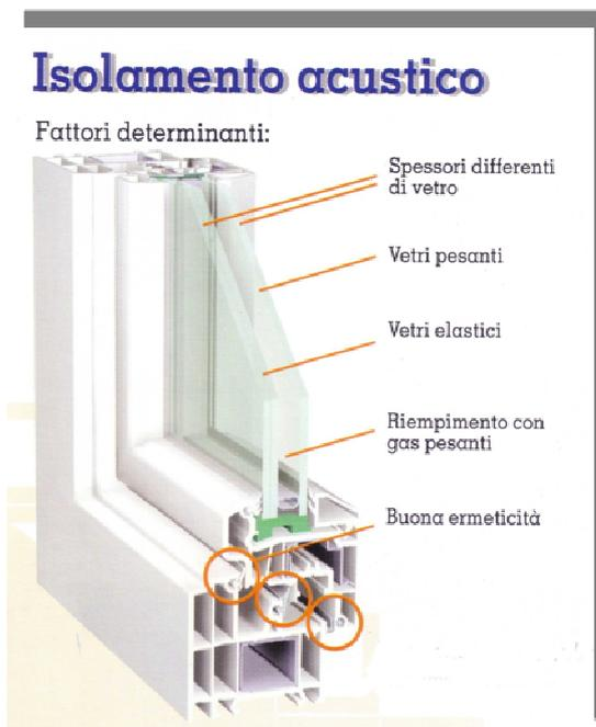
Generalmente, i serramenti ad elevata prestazione acustica sono strutturati in modo da prevedere un'intercapedine tra due lastre di vetro (il cosiddetto doppio vetro), intercapedine che può contenere un gas pesante che incrementi l'impedenza del sistema. Il tutto viene sigillato con una guarnizione (a tenuta).
