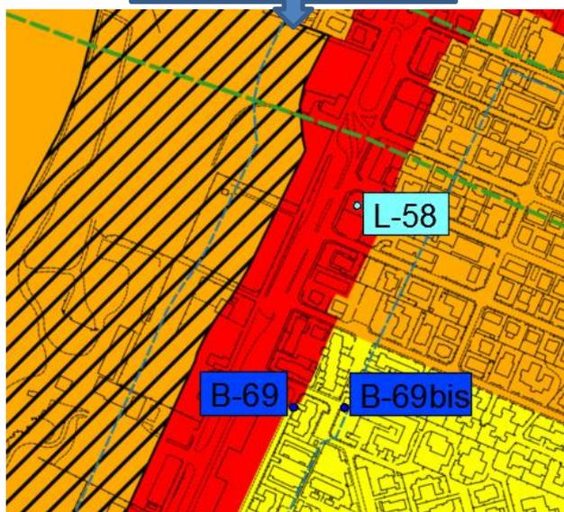
Tra il rilievo di lunga durata L58 (al primo fronte) e quello di breve durata B69bis (al limite della fascia Db), effettuati in parallelo, si ricava quindi una differenza di 17 dB sul contributo specifico di via Palestro: se i risultati sui due periodi di riferimento in L58 sono stati di 69 dBA diurno e 61.5 dBA notturno, si possono stimare a 100 m dal bordo strada (B69bis) livelli medi di 52 dBA diurni e 44.5 dBA notturni, compatibili con i limiti propri della classe II.
